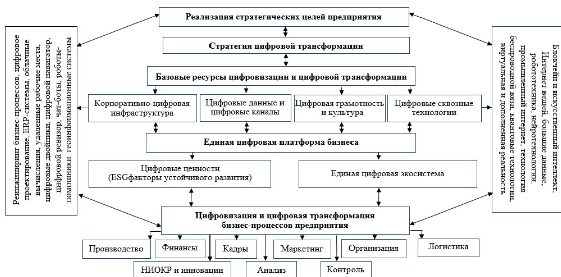
Рис. 1. Информационный контур цифровизации и цифровой трансформации промышленного предприятия.
